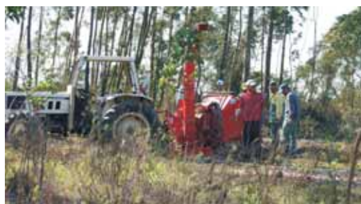
Destruição de sobrantes através de estilhaçador
