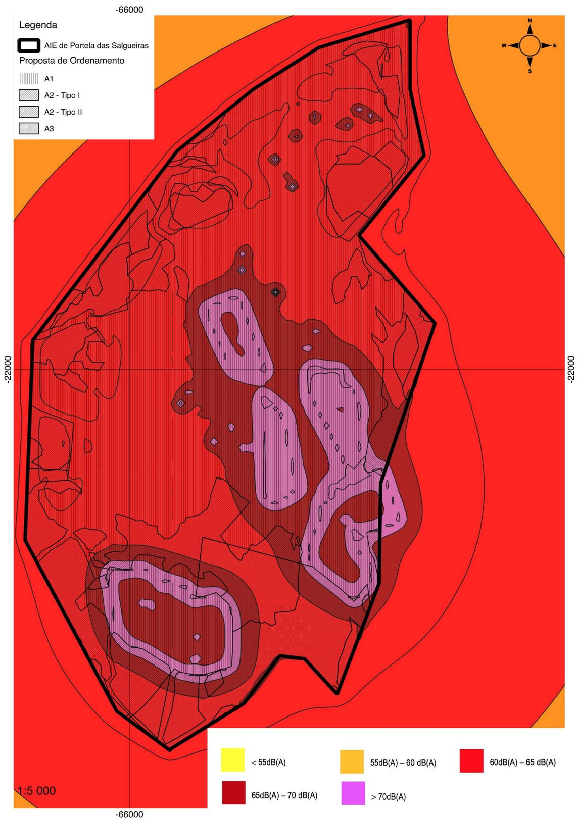
**Figura 7.4-4: Modelação de ruído particular da laboração das várias pedreiras na AIE da Portela das Salgueiras e Classificação do Solo Proposta**
